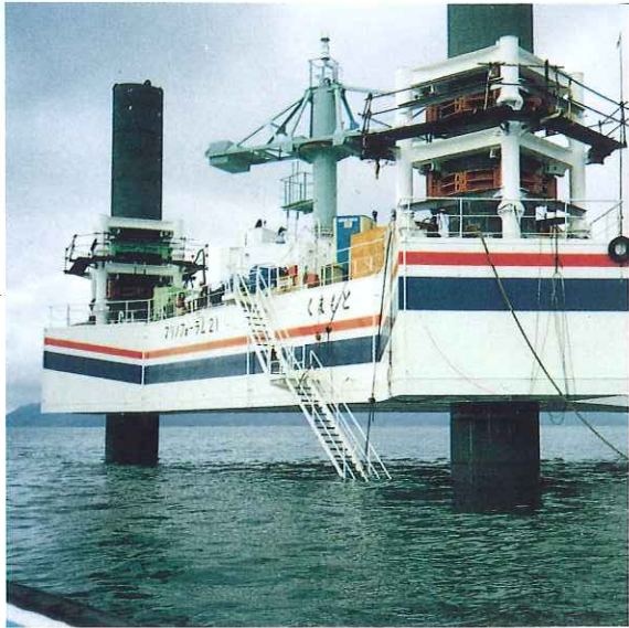
HC360T-2250型 ジャッキアップに利用
